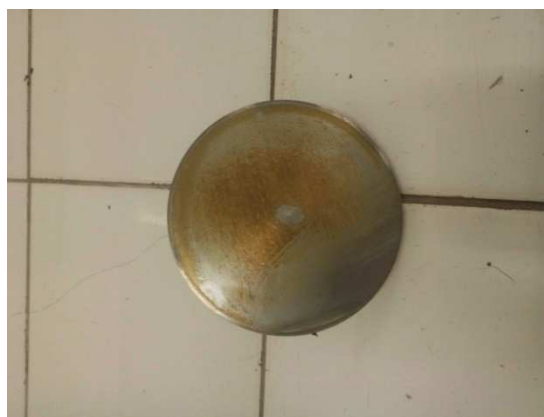
Figura 4.34: Eletrodo anodo pós-ensaio EK4
