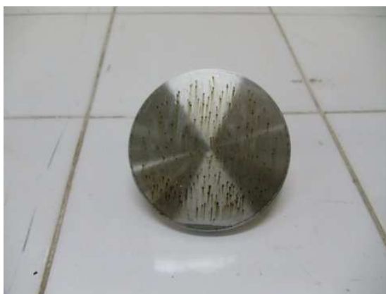
Figura 4.33: Eletrodo anodo pós-ensaio EK2
