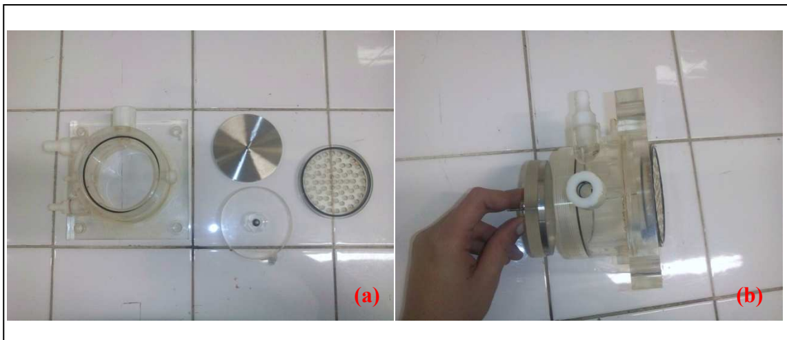
Figura 3.4 – (a) Elementos do compartimento do tanque; (b) Compartimento do tanque montado
