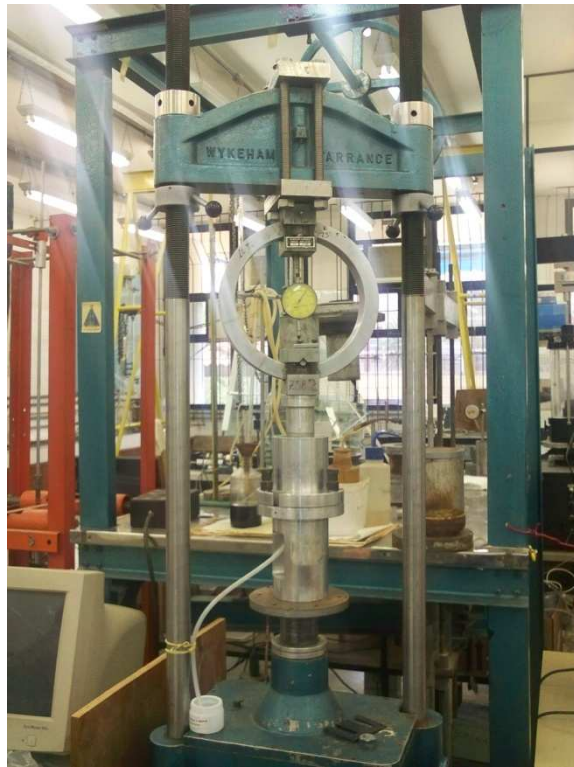
Foto 3.19: Ensaio de extração do líquido intersticial
