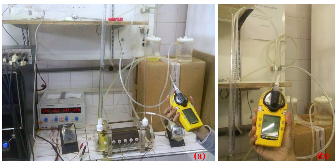
Figura 3.17 – (a) Detecção de gás no anodo; (b) Detalhe do módulo para bomba utilizado
