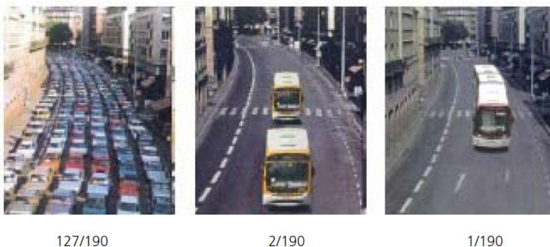
**Figura 11 – Quantidade de veículos necessária no transporte de passageiros**
