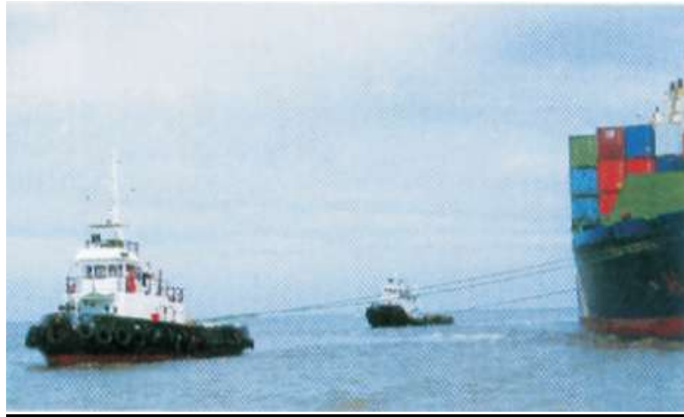
Figura 19: Rebocadores convencionais operando no método europeu, na proa do navio assistido.
