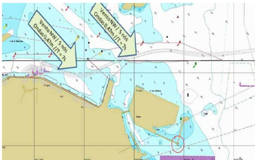
Figura 32: Trajetória percorrida pelo navio-tipo durante a manobra com 5 rebocadores, na condição “1.5”, com a representação da direção e intensidade do vento e ondas. Fonte: Transas Marine / Instituto BZ.
