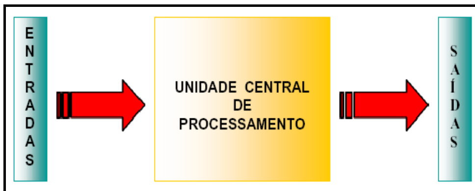
Figura 4.2 – Estrutura Básica de Funcionamento de um CLP
