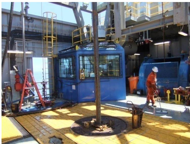
Figura IV.5: Piso da sonda da unidade marítima, com cabine do sondador ao fundo.
