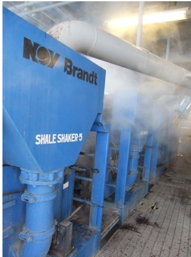
Figura IV.2: Foto das peneiras utilizadas para separação dos sólidos mais grosseiros do fluido de perfuração.
