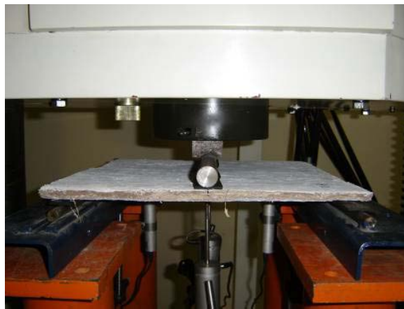
Figura 10: Ensaio de Flexão utilizado para simulação numérica.
