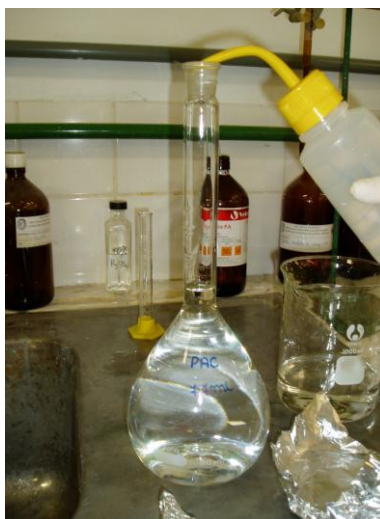
Figura 14: Diluição do PAC em um balão de 1 litro
