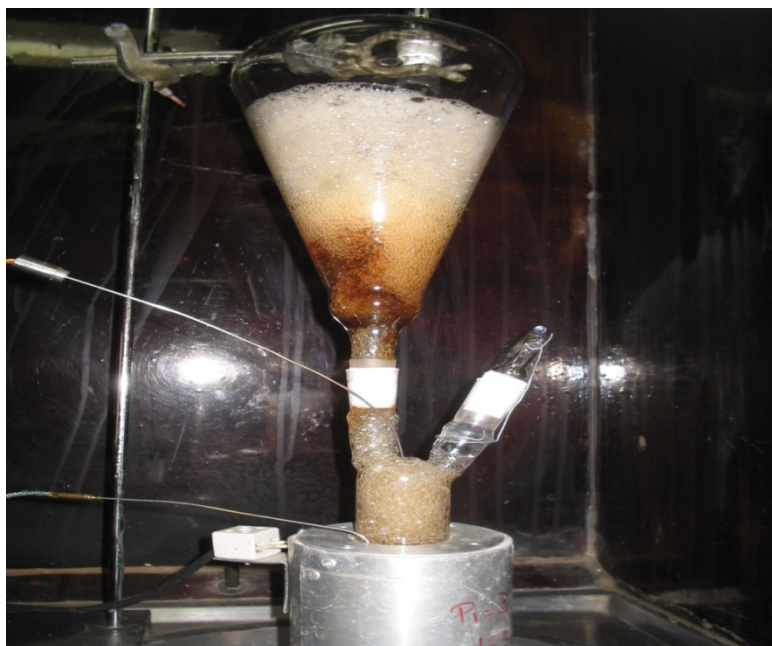
Figura 3.4 - Aquecimento do Chorume. O refluxo é detido pelo Erlenmeyer modificado.
