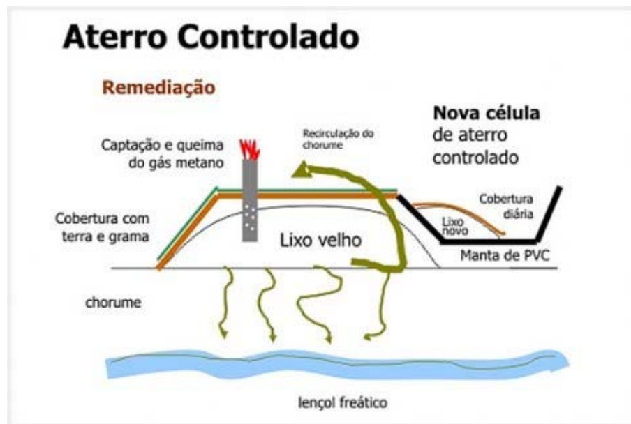
Figura 2.4 - Esquema de um aterro controlado (LIXÃO X ATERRO, 2010)
