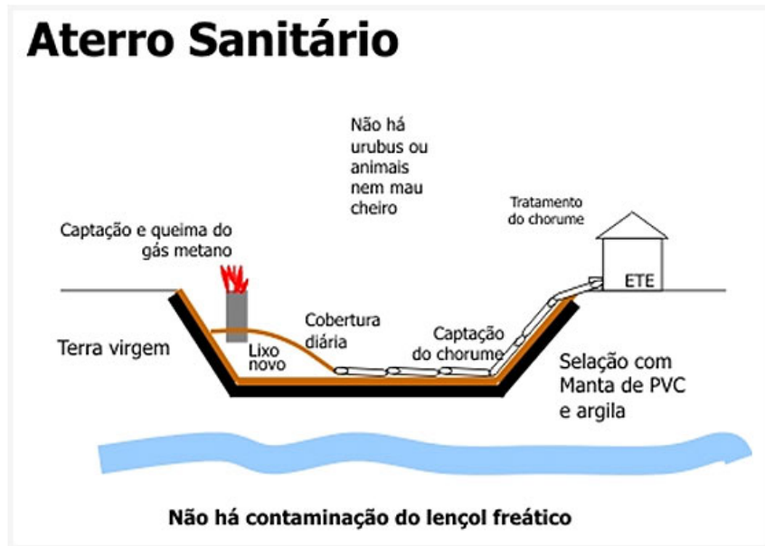
Figura 2.5 - Esquema de um aterro sanitário (LIXÃO X ATERRO , 2010)
