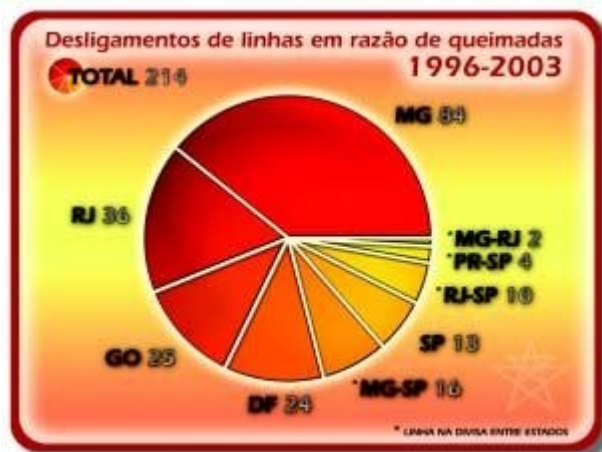
Figura 1.1 – Desligamentos de linhas em razão de queimadas em Furnas. Fonte: Revista Furnas [8].
