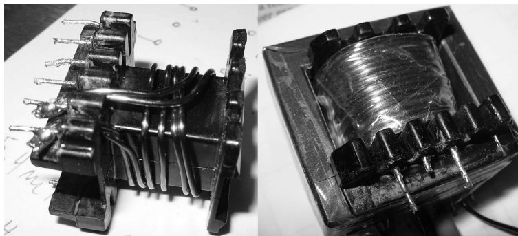
Figura 24: Transformador sendo enrolado.
