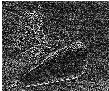
Fig.7 – Resultado da imagem 2 processada por cvSobel com parâmetros X=0, Y=1 e aperture size = 5.
