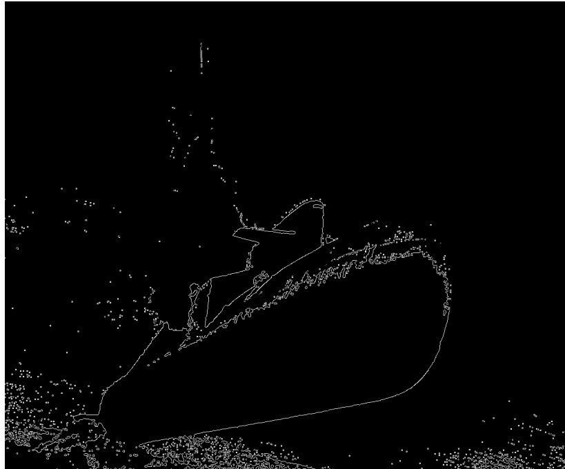
Fig.101 – Resultado da imagem 3 processada pelo programa de detecção de bordas utilizando CV_THRES_TO_ZERO_INV, thres1 = 60 e thres2 = 65.
