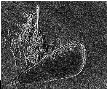
Fig.6 – Resultado da imagem 2 processada por cvSobel com parâmetros X=1, Y=0 e aperture size = 5.
