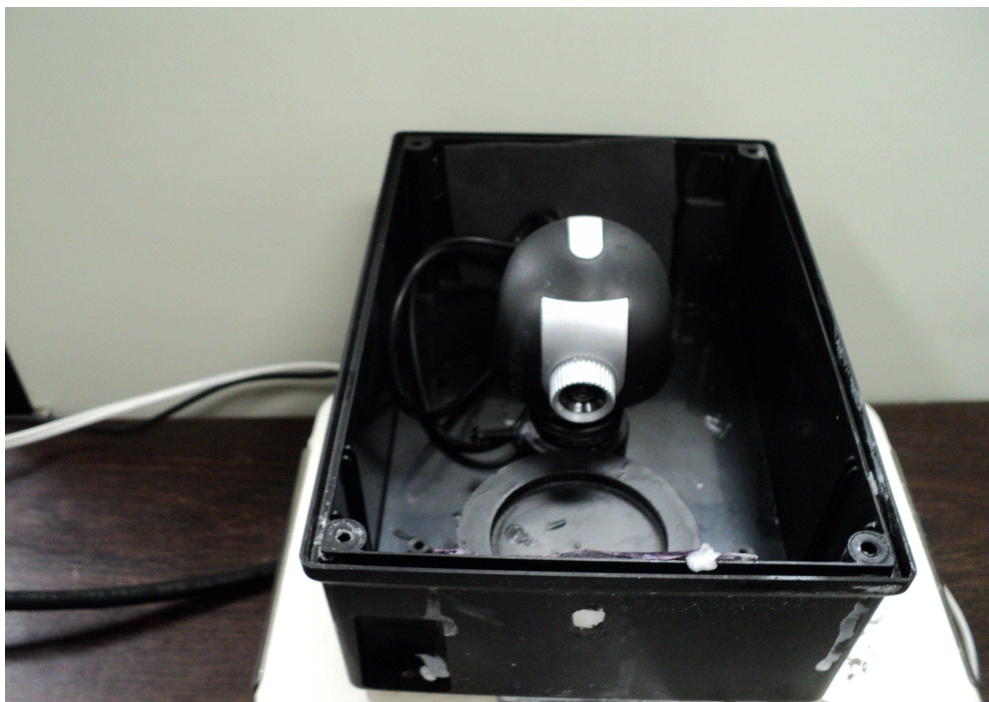
Figura 3.9: Primeira Visão Interna do Sistema. Na foto vê-se a webcam e o suporte para o copo. Ao fundo o EVA aderido à parede para evitar a entrada de luz externa pelo orifício aberto na caixa para passagem do conector USB. No outro lado da caixa, o furo para entrada de luz com o difusor fixado.
