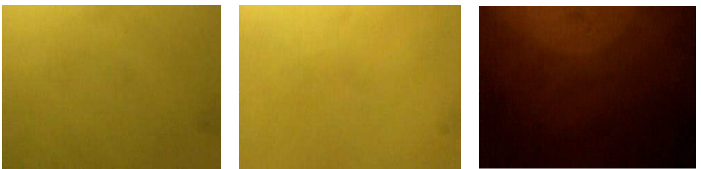
Figura 4.14 Imagens Obtidas ao se Inserir 0, 5,0 e 9,7 mL Respectivamente de Titulante na Segunda Rodada.
