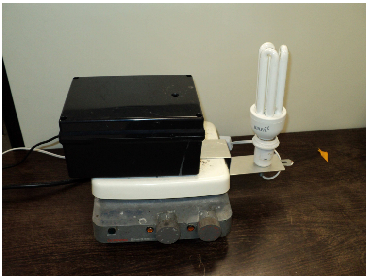
Figura 3.8: Sistema Pronto. A caixa modificada, com o furo na tampa para a colocação do titulante, o suporte para a lâmpada, o bocal de abajur fixado ao suporte e a lâmpada. O sistema está colocado sobre um agitador magnético
