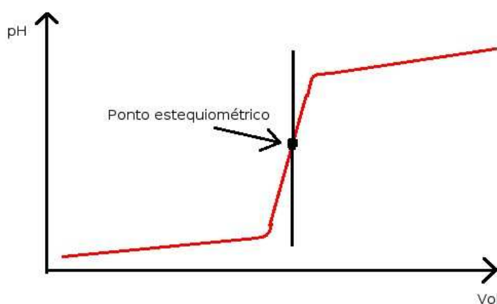
Figura 2.4: Esboço da Curva de Titulação de Volume de Titulado versus pH. Nota-se que na região do ponto estequiométrico a derivada primeira do gráfico é bastante grande.
