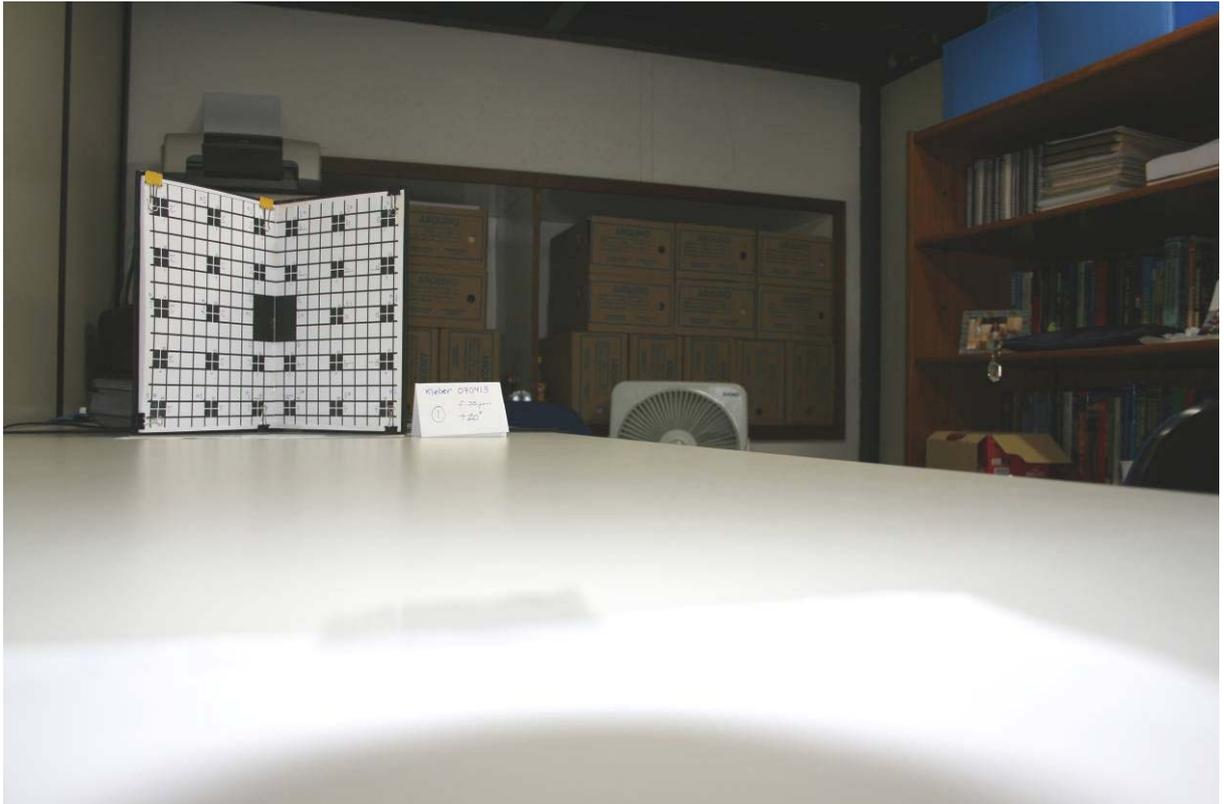
**Figura D.3** Foto tirada do *grid* com a câmera girada de  $+20^\circ$  em  $Y_{\text{CÂMERA}}$ .
