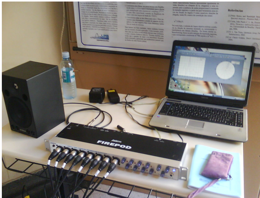
Figura 1.2: Protótipo do sistema para estimar a direção de chegada de um sinal de banda estreita.
