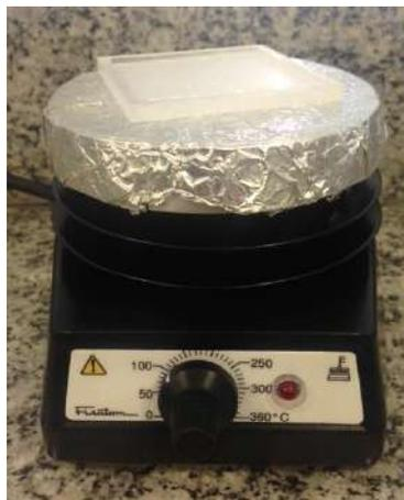
Figura 5.46: Placa aquecedora Fisatom utilizada para a secagem do molde e placa de vidro após a lavagem.
