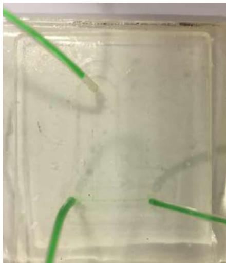
Figura 5.38: Microdispositivo fabricado em UA através de molde em PMMA através de litografia macia e ligado com o meio externo.
