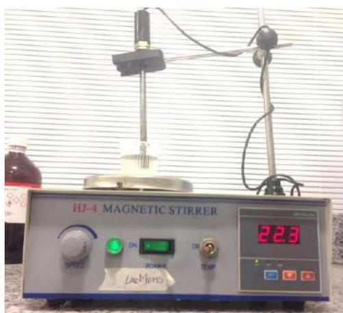
Figura 5.22: Sensor utilizado para medir a temperatura da UA após aquecida.
