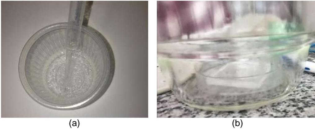
Figura 5.43: (a) Bolhas resultantes da mistura entre o pré-polímero e o agente de cura para a formação do PDMS e (b) polímero levado ao vácuo durante 1h para a remoção destas bolhas.
