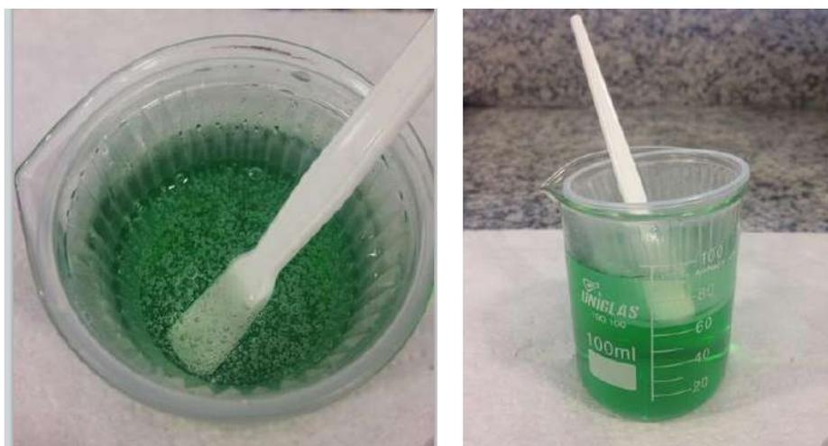
Figura 5.21: Banho-maria da fotorresina cujo objetivo é diminuir sua viscosidade, onde em verde é a água aquecida, usada somente para dar um contraste e apresentar melhor a UA que é transparente e está contida dentro do copo de plástico.
