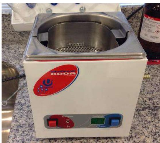
Figura 5.28: Banho de ultrassom utilizado no processo de limpeza.
