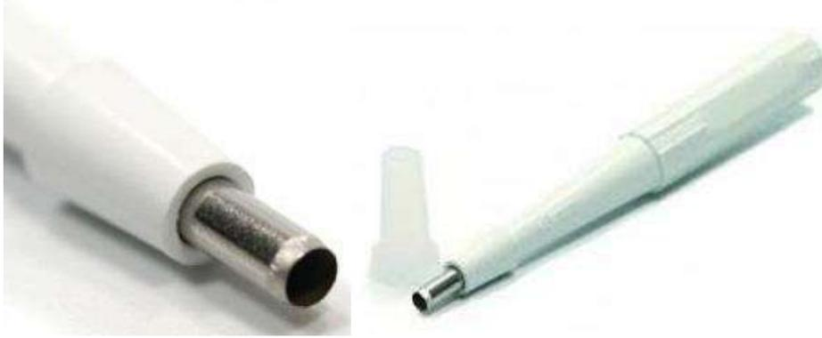
Figura 5.33: *Punch* dermatológico com diâmetro interno de 1,25mm utilizado para realizar as furações para a conexão das mangueiras com o meio externo.
