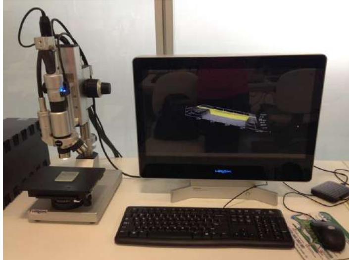
Figura 5.13: Microscópio digital *Hirox Digital Microscope* modelo *KH.8700* efetuando a caracterização do microseparador.
