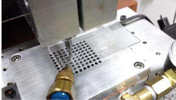
Figura 5.9: Detalhe da fabricação do molde em PMMA na microfresadora de controle numérico computadorizado (CNC) da empresa “*Minitech Machinery*”.
