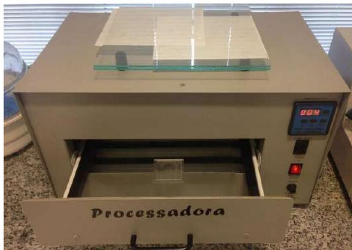
Figura 5.26: Máquina fotoexpositora (processadora de carimbos), utilizada no presente trabalho.
