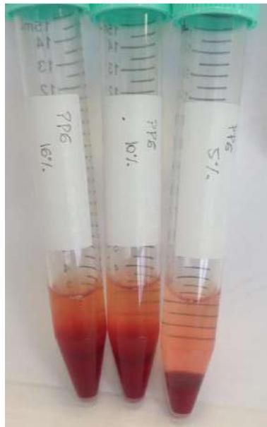
Figura 6.9: Amostras já diluídas armazenadas em tubo tipo falcon e com as porcentagens de hematócritos identificadas em 5%, 10% e 16%.
