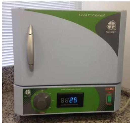
Figura 5.56: Estufa da marca Sterilifer utilizada para a segunda parte do processo de cura do PDMS.
