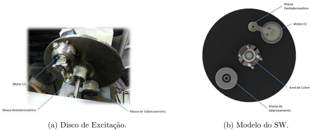
Figura 29: Detalhes da montagem do disco de excitação.
