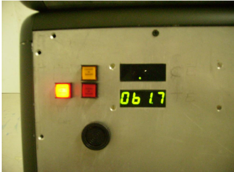
Figura 5.17 – Displays exibindo potência de saída
