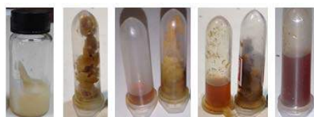
Figura 4.23 – Produtos coletados produzidos nos ensaios de pirólise de misturas de polietileno de alta densidade/folhas secas de Terminalia catappa em diferentes proporções. Da esquerda para direita: 1/0, 2/1, 1/1, 1/2 e 0/1 (m/m) (vazão de N 2 de 80 mL min -1 e temperatura de pirólise de 500 °C).
