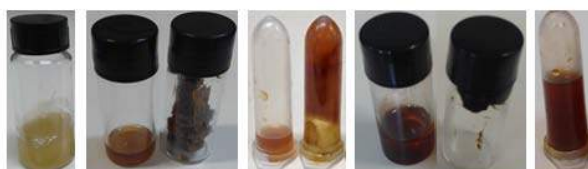
Figura 4.22 – Produtos coletados nos ensaios de pirólise de misturas de polipropileno/folhas secas de Terminalia catappa em diferentes proporções. Da esquerda para direita: 1/0, 2/1, 1/1, 1/2 e 0/1 (m/m) (vazão de N 2 de 50 mL min -1 e temperatura de pirólise de 450 °C).
