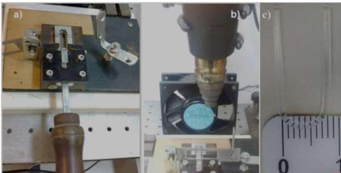
Figura 19 – Equipamento empregado na moldagem da fibra óptica plástica. a) Forma para molde da fibra em “U” desenvolvida pelo LIF. b) Detalhes da sopradora de ar quente utilizada para aquecer os trechos de fibra e moldá-los em forma de “U” e da ventoinha utilizada para resfriar todo o conjunto; c) Medida do diâmetro do sensor em “U”.
