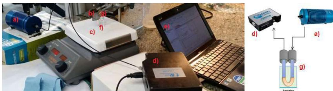
Figura 18 – (à esquerda) Montagem em bancada dos instrumentos que compõem o *setup* 2: a) fonte de luz branca; b) sensor no suporte; c) agitador magnético; d) espectrômetro; e) *software* SpectraSuite; f) suspensão de bactéria; g) sensor em “U” imobilizado preso no suporte. (à direita) Ilustração simplificada do *setup* 2.
