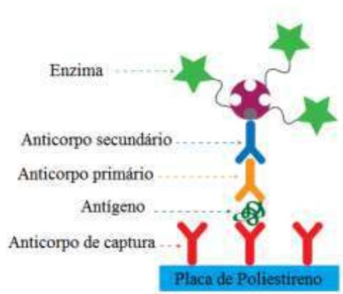
Figura 5 – Representação do mecanismo de detecção por ELISA. Fonte: Adaptado de RICA e STEVENS (2012).
