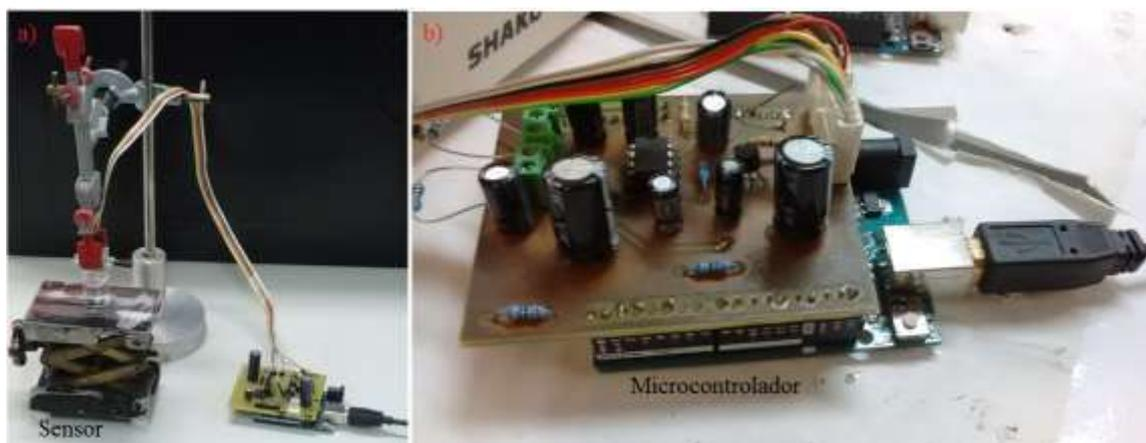
Figura 17 – a) Foto do sensor em teste; b) Foto do circuito optoeletrônico do *setup* 1.
