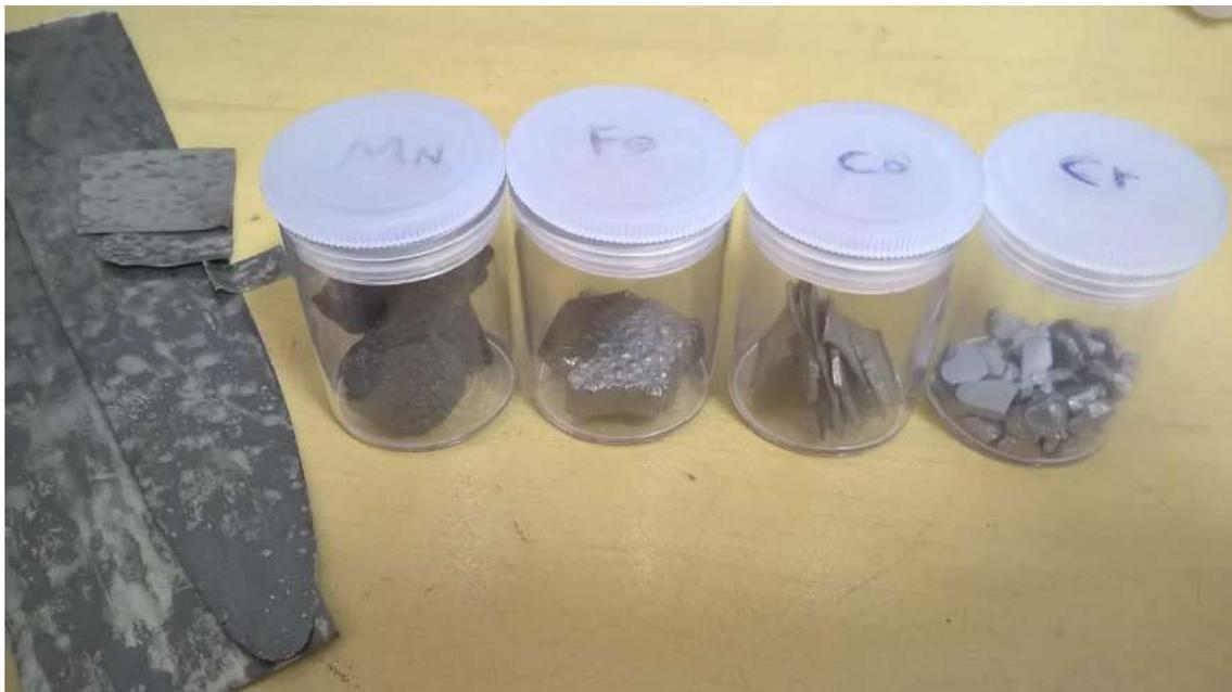
Figura 3.1. Componentes da liga antes da fusão. Níquel, Manganês, Ferro, Cobalto e Cromo (da esquerda para a direita).
