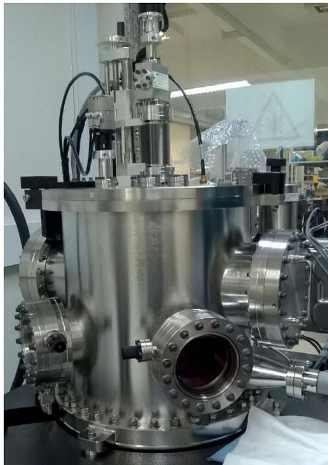
Figura 3.7. Equipamento de recobrimento de paládio.
