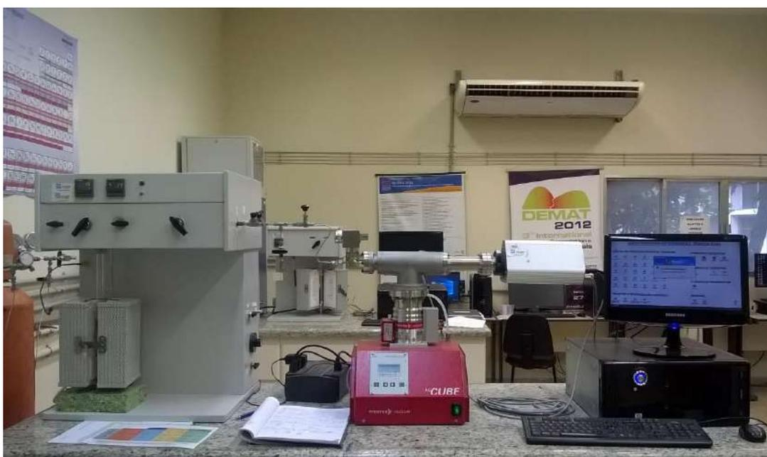
Figura 3.6. Equipamento de Espectroscopia de Dessorção Térmica.
