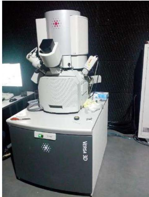
Figura 3.9. Microscópio Eletrônico de Varredura de alta definição.
