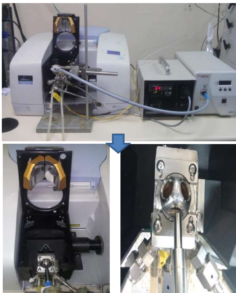
Figura 3.8- Unidade de DRIFTS utilizada no experimento.
