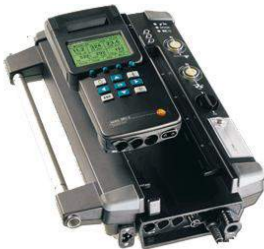
Figura 3.8 – Analisador de gases TESTO modelo 350 XL equipado com células eletroquímicas capazes de determinar as concentrações de NO, NO 2 , CO e O 2 . Fonte: CONTROL ANALYTICS, INC., 2016.
