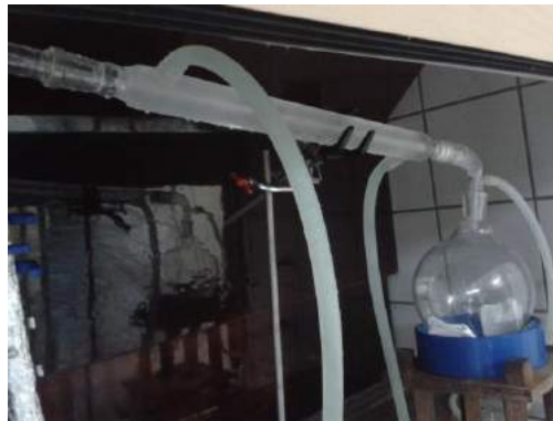
Figura 3-2 – Condensador e balão de coleta – Unidade de destilação de estireno Fonte: elaboração própria.
