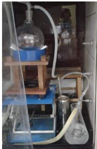
Figura 3-3 – Cold trap – Unidade de destilação de estireno. Fonte: elaboração própria.
