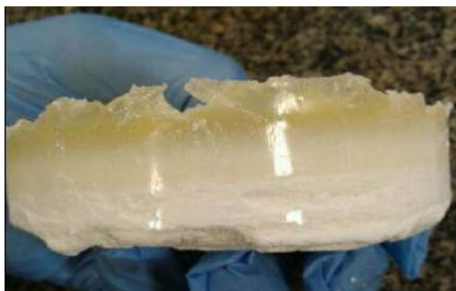
Figura 5-25 - Camadas sólidas na parte superior do sistema obtido do experimento S4. Fonte: elaboração própria.
