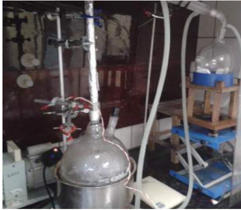
Figura 3-1 – Unidade de destilação de estireno. Fonte: elaboração própria.
