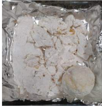
Figura 5-58 - Polimerização casca núcleo com uma hora e meia na etapa de polimerização em suspensão após secagem.
