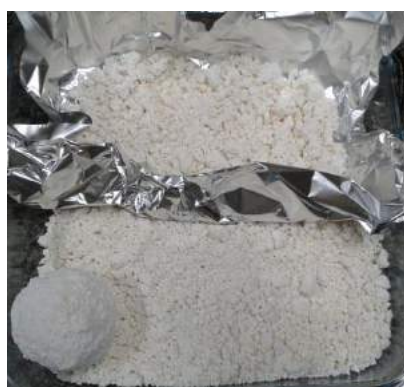
Figura 5-57 – Polimerização casca núcleo com uma hora na etapa de polimerização em suspensão após secagem.
