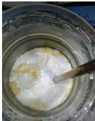
Figura 5-59 – Sistema no final da polimerização casca núcleo com uma hora e meia na etapa de polimerização em suspensão.
