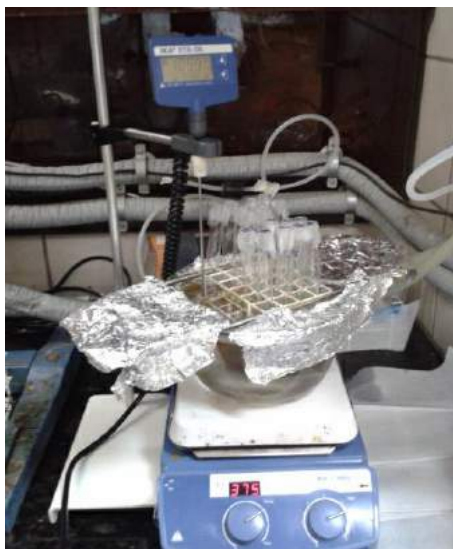
Figura 3-4 - Unidade experimental usada para a polimerização em massa.
