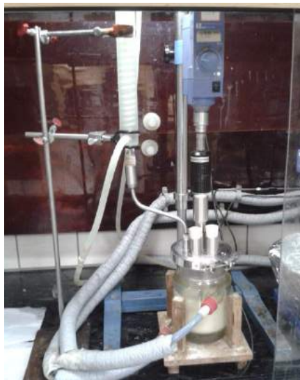
Figura 3-5 - Unidade experimental polimerização em suspensão e em emulsão.
