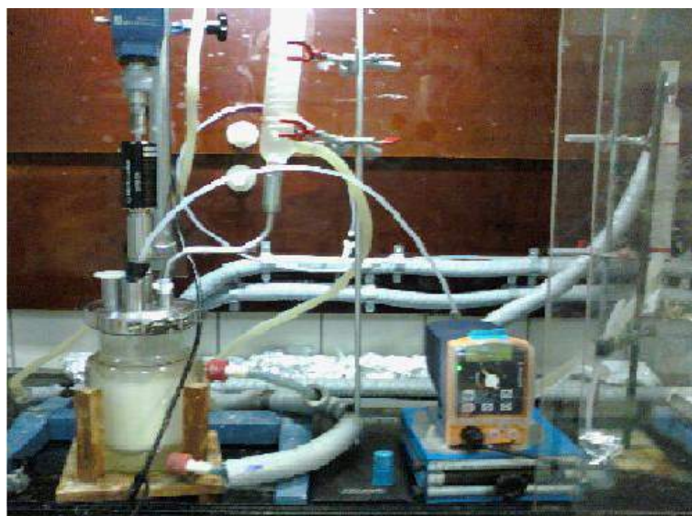
Figura 3-6 – Unidade experimental polimerização suspensão-emulsão simultânea. Fonte: PINTO, 2013.
