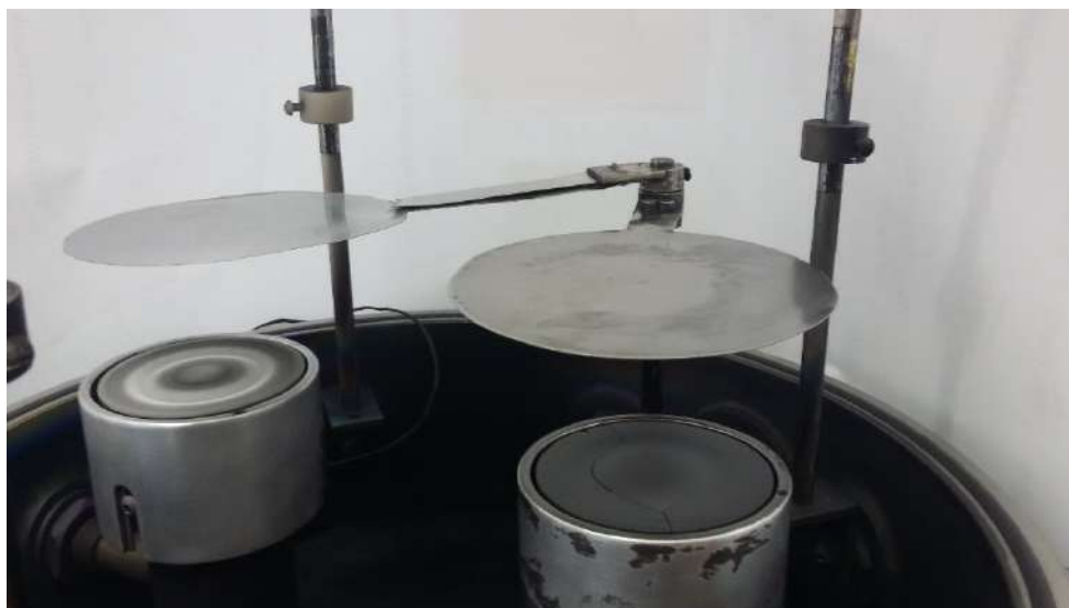
Figura 27 – Detalhe da Câmara interna, mostrando os shutters sobre os alvos
