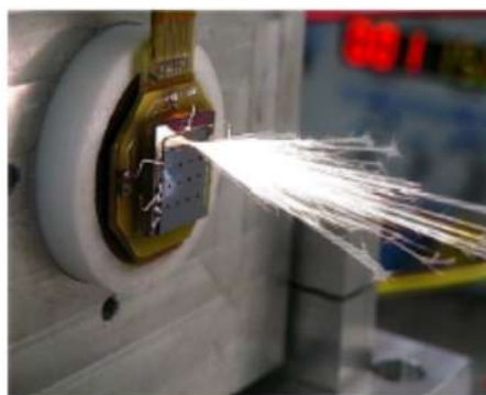
Figura 22 - Funcionamento do MEMS micropropulsor (ROSSI, 2015, pg. 116)
