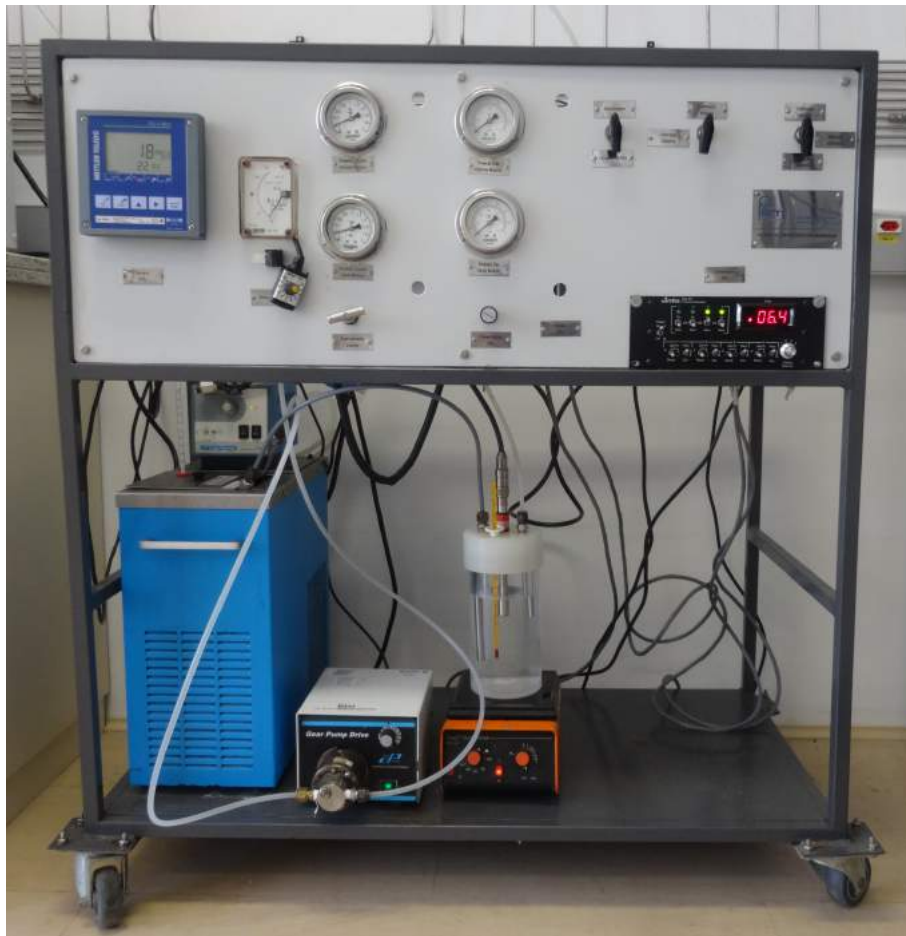
Figura 3.7: Sistema de contactores com membranas
