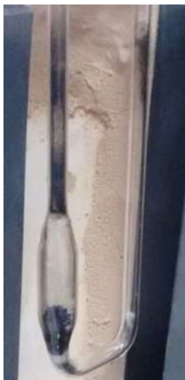
Figura 4.18 – Reator entupido devido à formação de carbono filamental decorrente da decomposição do CH 4 no catalisador de Ni-C.
