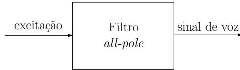
Figura 2.1: Processo de geração de voz humana no codificador LPC.
