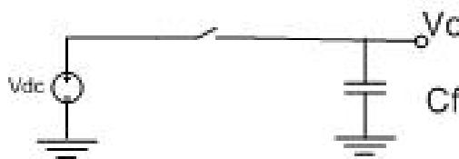
Figura 5.5 – Circuito de teste da chave analógica.
