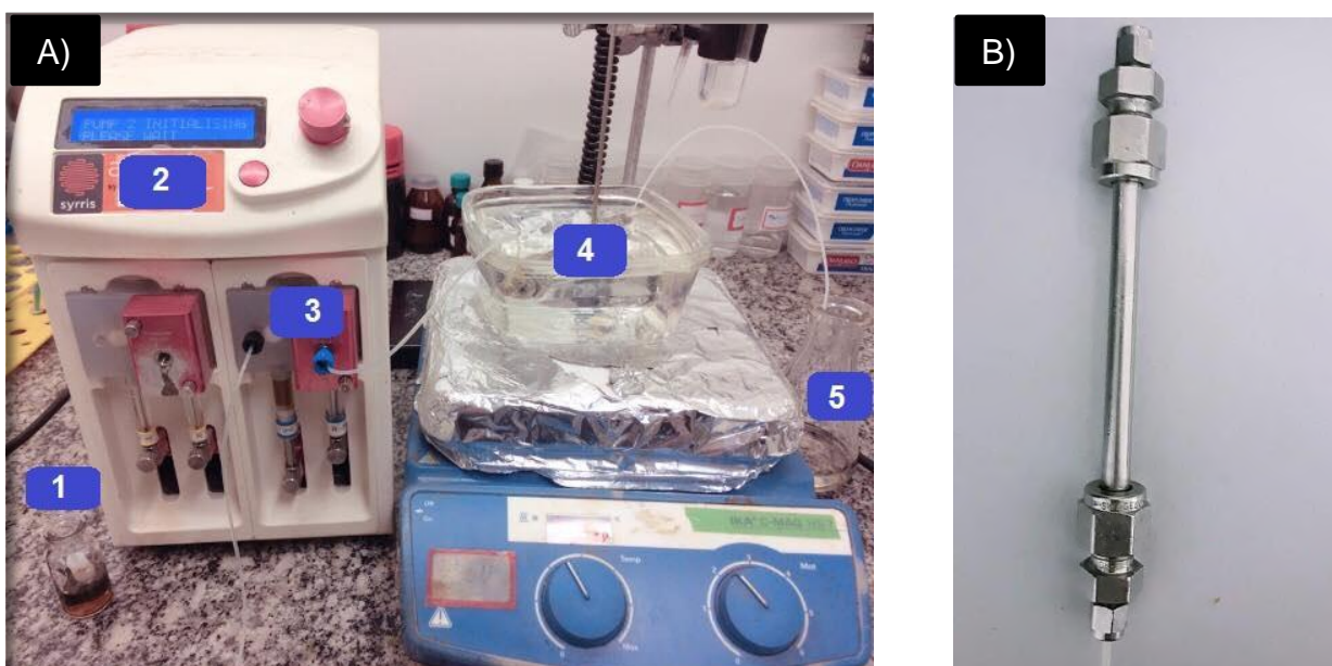
Figura 10. A) Sistema de fluxo contínuo; B) Leito fixo preenchido com a lipase.
