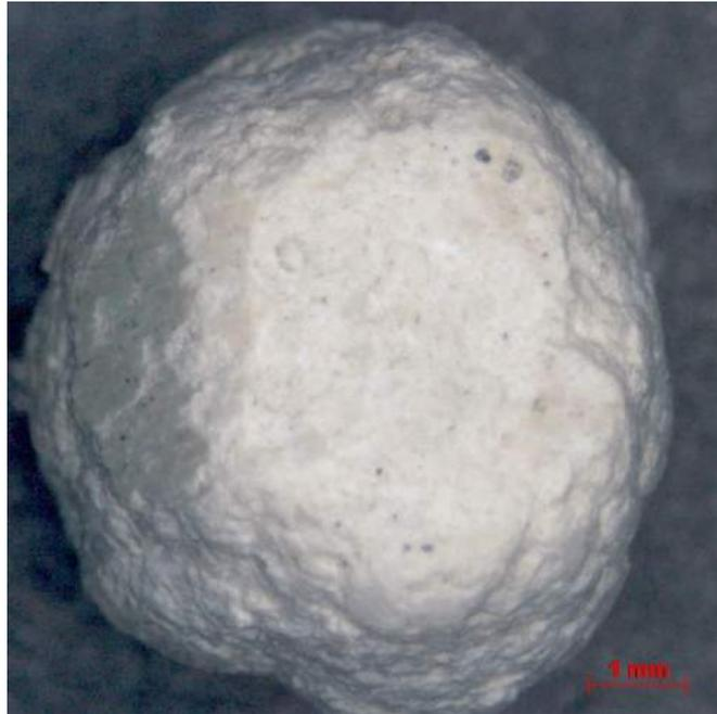
**Figura 15.** Imagem de palygorskita pelotizada com 10% WAX (MERCK) e 20% Cimento Portland 32, como aglomerantes, geradas por microscópio óptico estereoscópio.
