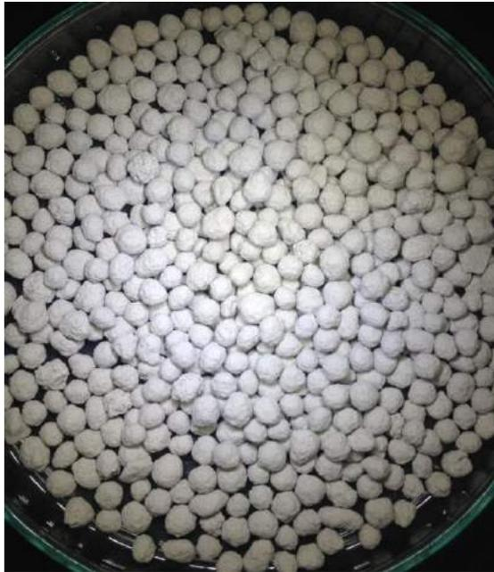
**Figura 14.** Imagem das pelotas produzidas na faixa granulométrica de 4,75 e 2,8 mm utilizadas nos ensaios de adsorção
