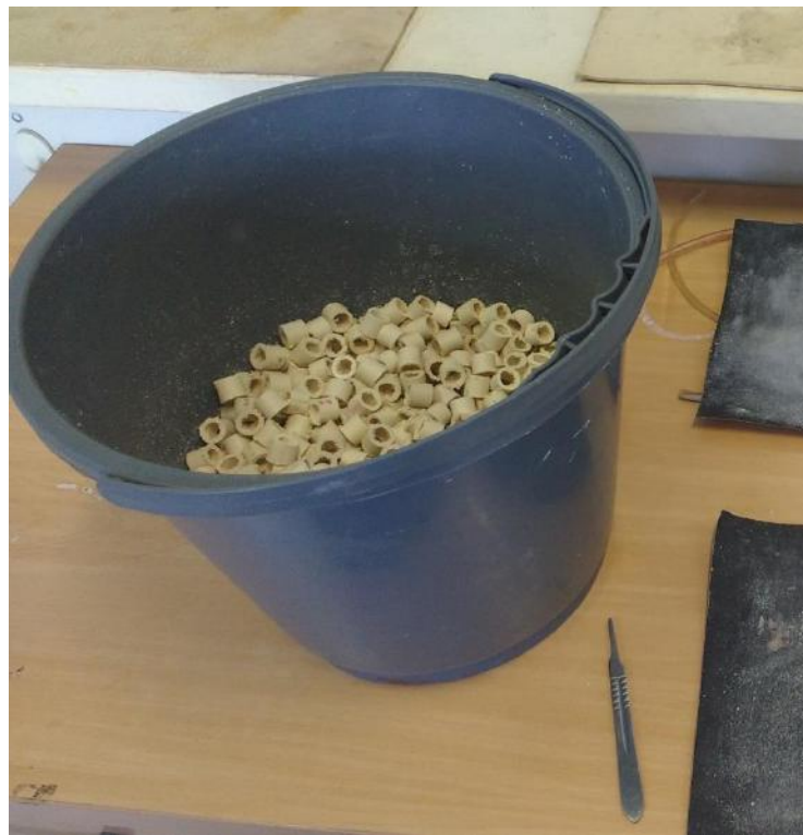
Figura 12 – Anéis de Raschig montados para utilização como recheio na coluna de absorção.
