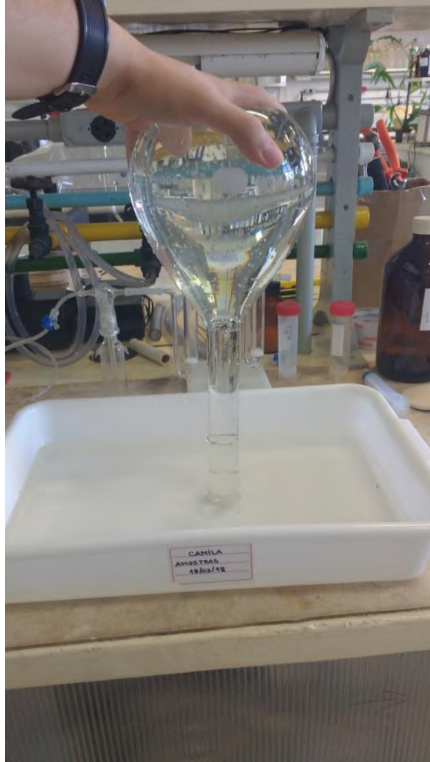
Figura 15 – Medição da vazão de mistura gasosa pelo arraste de coluna de água.
