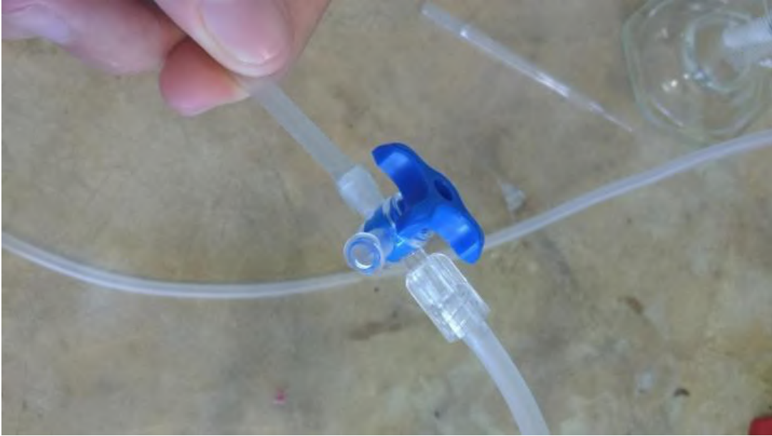
Figura 16 – Conector de 3 vias para controle da vazão e coleta de gases
