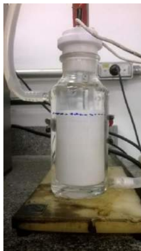
Figura 38: Imagem da Emulsão Modelo A ao final do processo de separação eletrostática.
