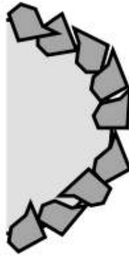
Figura 10: Partículas parcialmente molháveis por ambas as fases, orgânica e aquosa, e sua localização na interface do sistema (MYERS, 1999).
