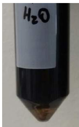
Figura 32: Imagem da Emulsão P Deionizada após uma semana de repouso.
