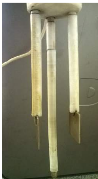
Figura 22: Conjunto de eletrodos do sistema de eletrocoalescência.
