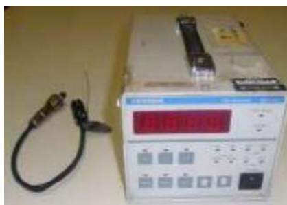
Figura I.2 – Sistema de medição da razão de equivalência da mistura. Fonte: (ALMEIDA, 2013)
