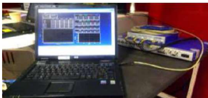
Figura I.4 – Sistema para aferir a pressão na câmara de combustão. Fonte: (ALMEIDA, 2013)
