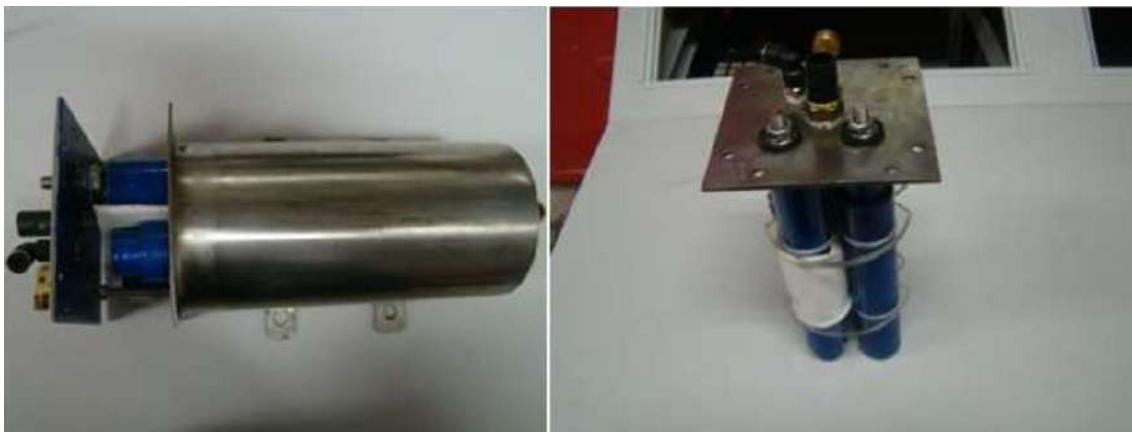
Figura I.8 – Sistema de eletrólise da água com reator de núcleo tubular. Fonte: (ALMEIDA, 2013)
