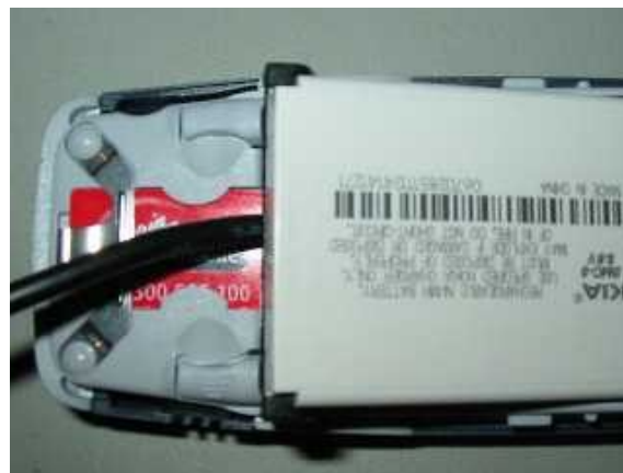
Figura 3.5 – O cabo F-Bus entra por debaixo da bateria
