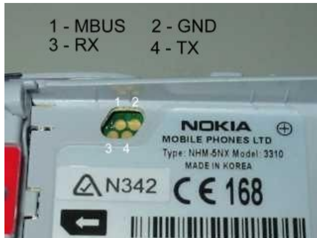
Figura 3.4 – Os pinos 1, 2, 3 e 4 são usados para conexão F-BUS e M-BUS
