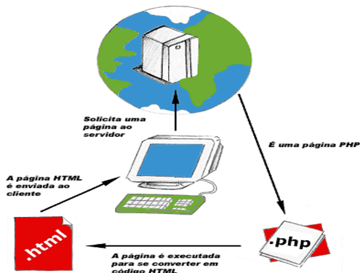
Figura 01 – Diagrama de funcionamento do PHP
