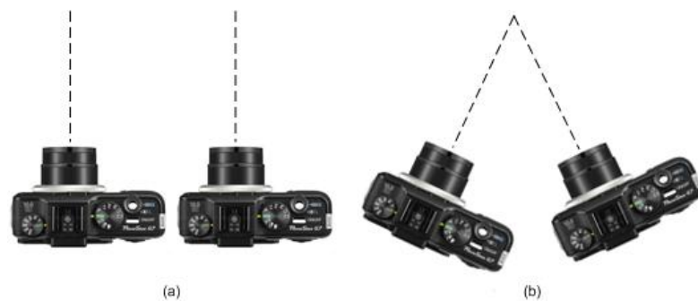
Figura 5 – Arranjo das câmeras para o vídeo estereoscópico: (a) eixos paralelos; (b) eixos convergentes.
