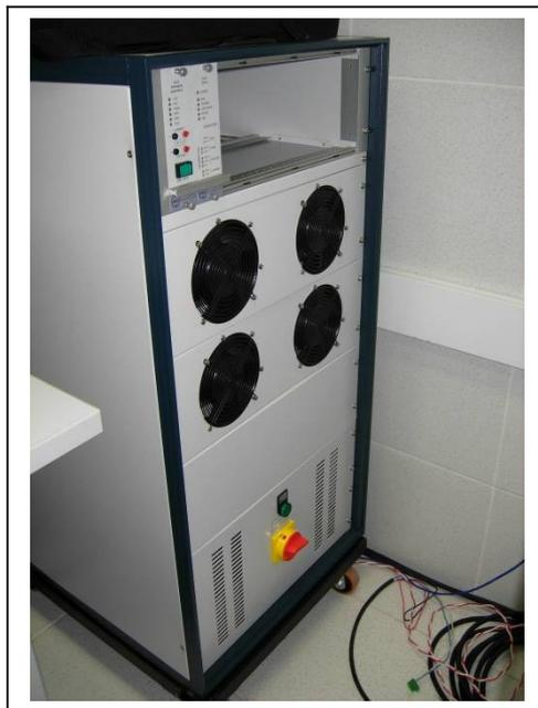
Figura 3-5. A&C CLT. Painel de teste de vida cíclica de baterias.
