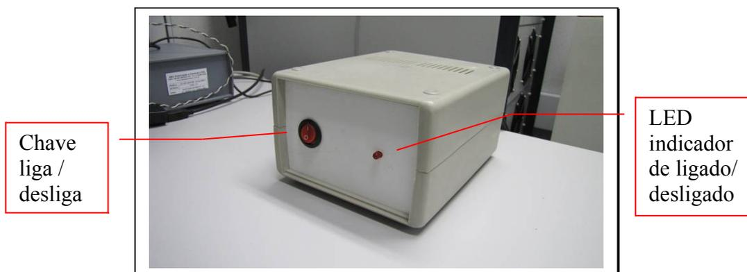
Figura 4-26. Protótipo do sistema de controle de umidade - vista frontal.
