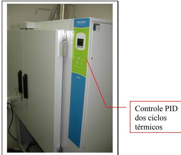
Figura 3-6. Estufa onde serão realizados os ensaios de durabilidade.
