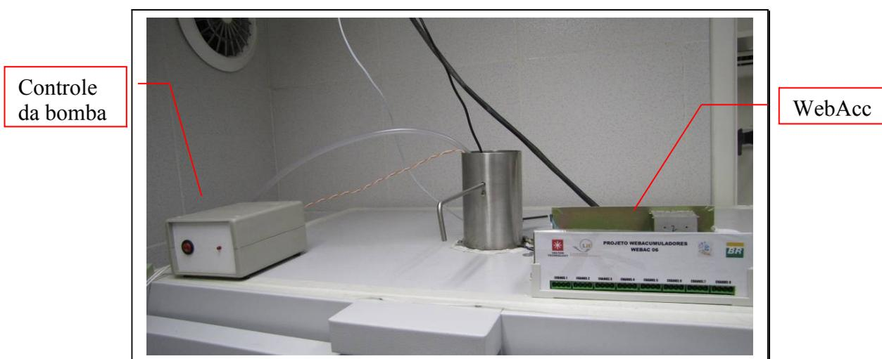
Figura 5-13. Controle da bomba de água e WebAcc.
