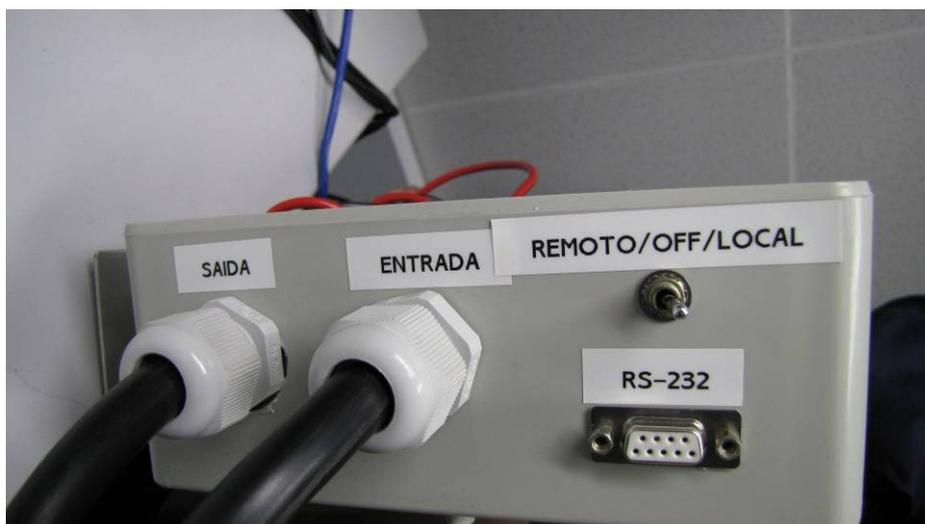
Figura 4-15. Protótipo de controle do painel CLT - conexões.
