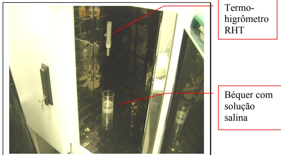
Figura 4-20. A solução no interior da estufa para testes.
