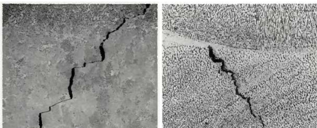
Figura 24: Morfologia típica do trincamento retardado em aço baixa liga: degraus (Adaptado de [76]).
