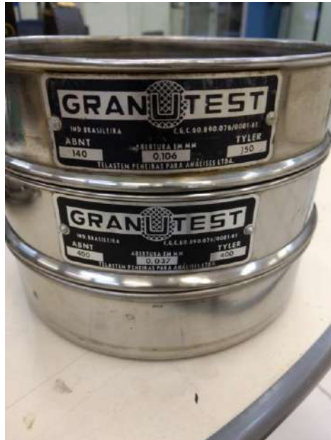
Figura 15 Peneiras utilizadas na peneiração do pó da amostra de Ti_{0,5}Fe_{0,1}V_{0,4} .
