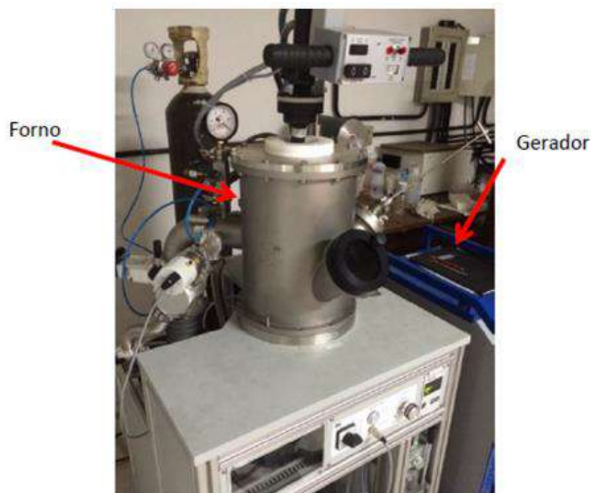
Figura 12 Forno a arco elétrico, marca Bühler, composto pela câmara do forno e pelo gerador de corrente.
