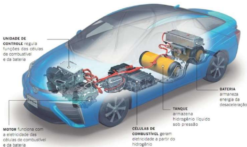
Figura 1 Principais componentes do veículo Mirai, da Toyota, que utiliza hidrogênio líquido em cilindros pressurizados. Adaptado de [9].
