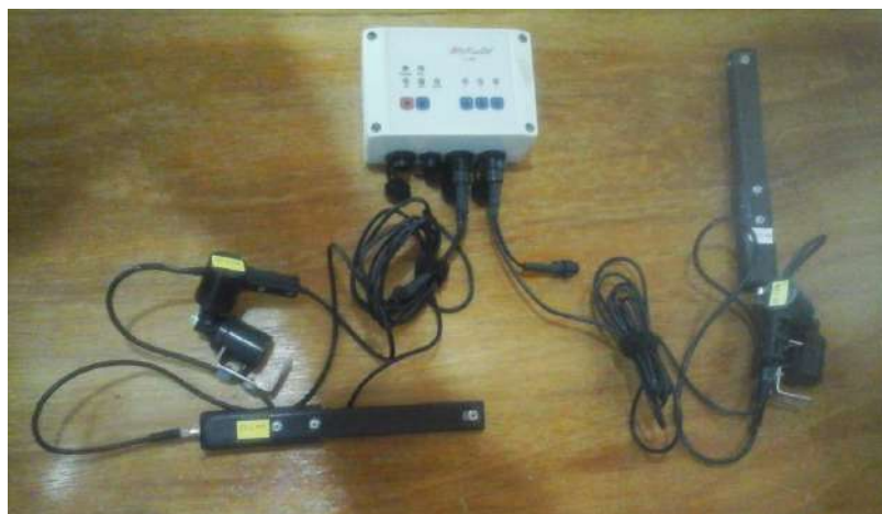
Figura 9: Sistema de aquisição. Sensores de força e sensores de ângulos conectados a caixa máster.
