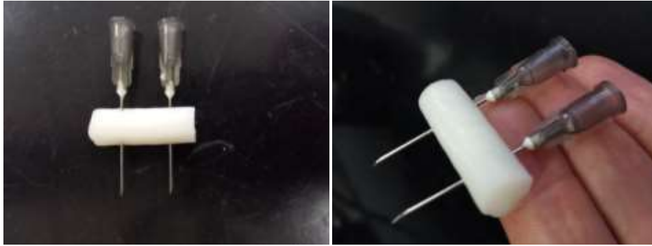
Figura 28: Phantom de gelatina e sílica. O phantom possui um orifício interno longitudinal, que será visto nas imagens de BMU. Foram inseridas duas agulhas hipodérmicas, transversais ao phantom , para servir como marcadores nas imagens de BMU-2D.
