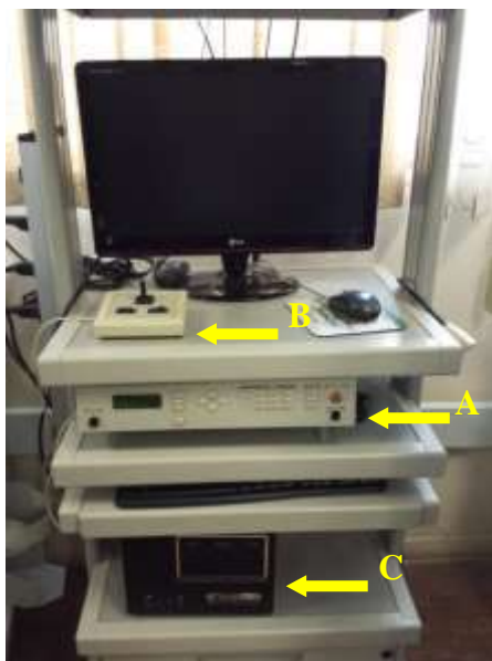
Figura 10: Equipamento controlador de movimento, indicado por A. Joystick, indicado por B e hardware de aquisição de imagens de BMU.
