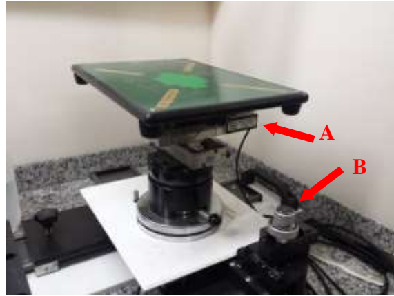
Figura 9: Plataforma de manuseio de ratos. A seta identificada por A mostra os estágios lineares e motores DC que fazem o deslocamento da plataforma. A seta identificada por B mostra os dois acionadores para deslocamento manual da plataforma.
