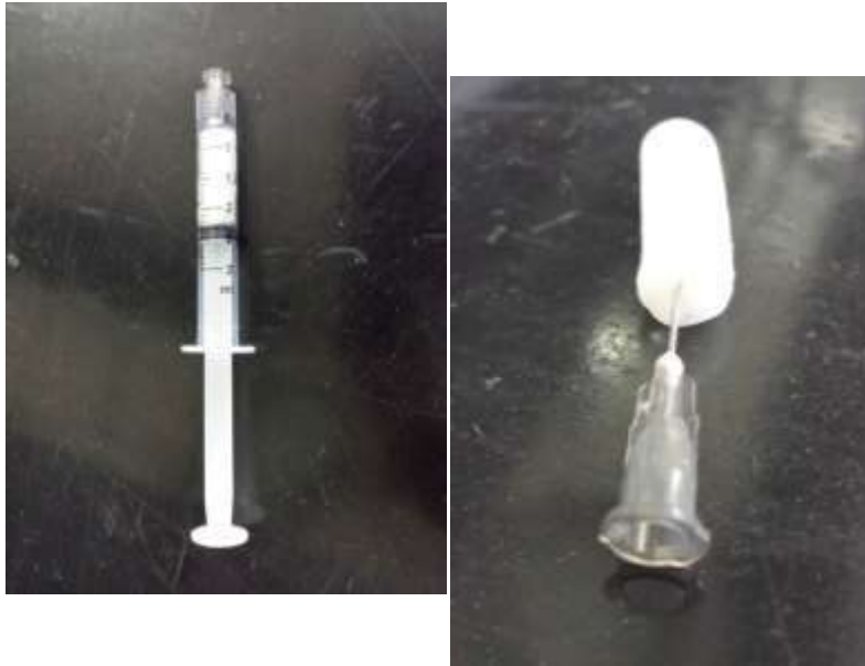
Figura 26: À esquerda, phantom na seringa utilizada como molde para construí-lo. À direita, após ser retirado da seringa, ainda com a agulha hipodérmica inserida no interior do phantom e que moldou o orifício interno durante o resfriamento do phantom .
