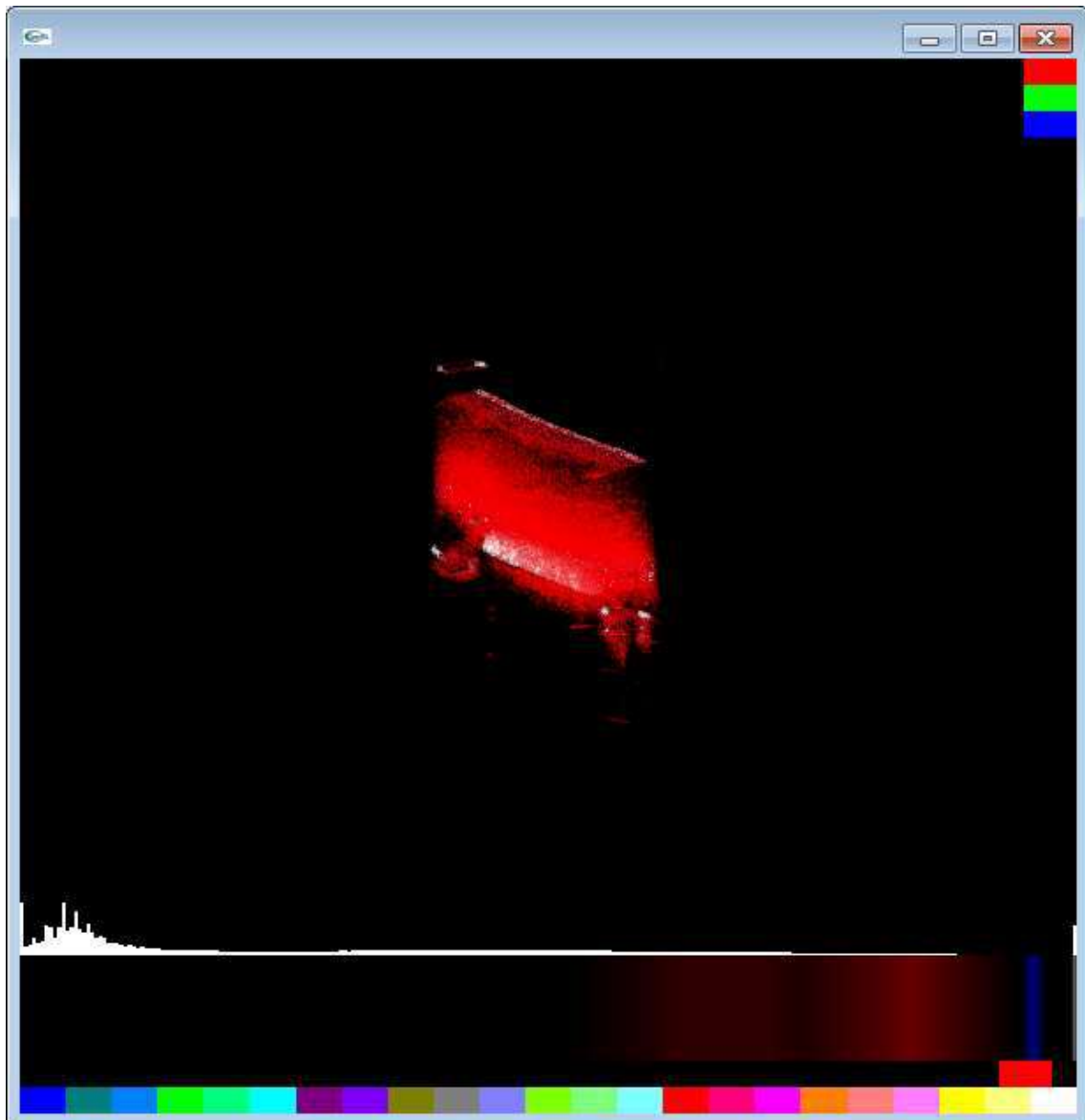
Figura 38: Imagem de BMU-3D do phantom de gelatina, visto de perfil. A parede do phantom foi colorida de vermelho e o orifício interno de branco.
