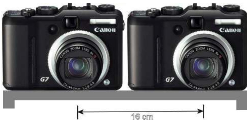
Figura 3.2: Par de câmeras Canon Powershot G7 posicionadas no suporte
