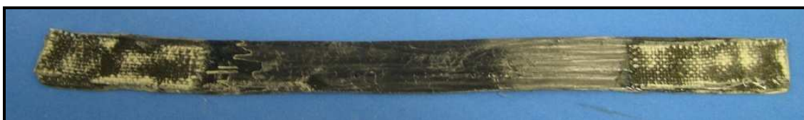
Figura 12 - Corpo de prova para ensaio de tração do laminado de fibra de carbono.
