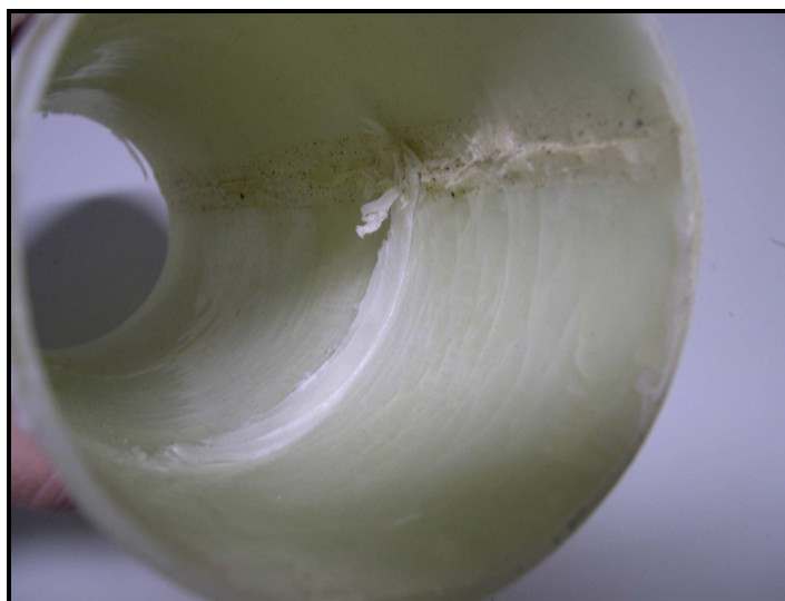
Figura 43 – Vista interna do tubo de fibra de vidro fraturado após ensaio de pressão hidrostática externa.
