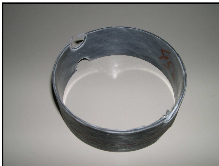
Figura 27 - Corpo de prova de tubo híbrido para ensaio de anel.
