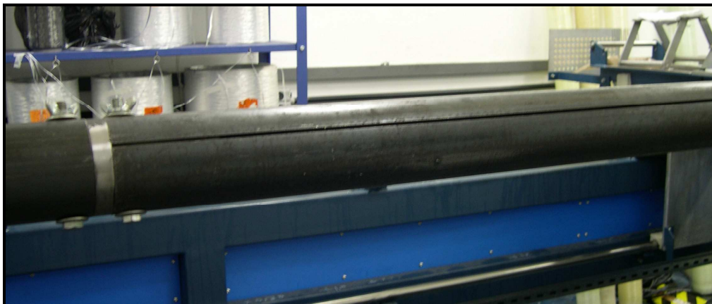
Figura 15 - Mandril colapsável cuja superfície recebeu desmoldante.
