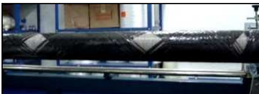
Figura 21 - Tubo híbrido com camada de fibra de carbono enrolada a \pm 45^\circ .
