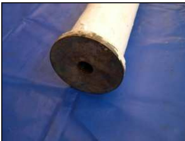
Figura 29 - Tubo preparado para o ensaio de pressão externa.
