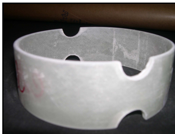
Figura 26 - Corpo de prova para ensaio de anel do tubo de fibra de vidro.
