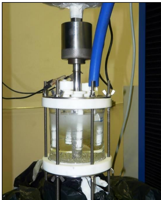
Figura 32: Célula eletrolítica usada para hidrogenação da amostra sob tensão.
