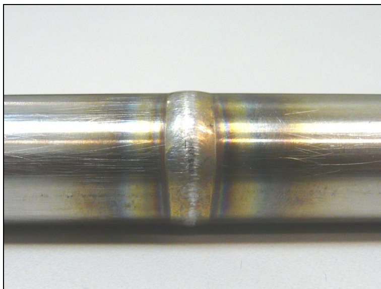
Figura 31: Tubo de AISD SAF 2507 na condição como soldado.
