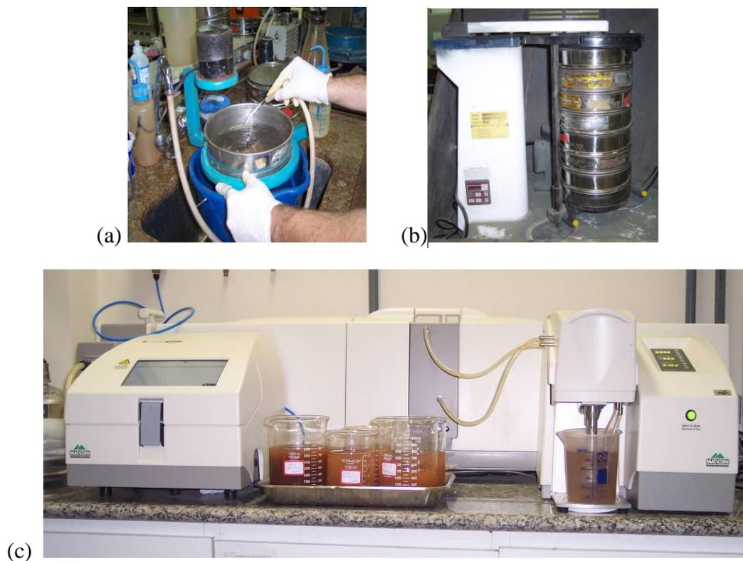
Figura 3.3 – Peneiramento híbrido (a) a úmido , (b) a seco no RO-TAP® e (c) técnica de espalhamento de luz no *Mastersizer 2000* da *Malvern*.
