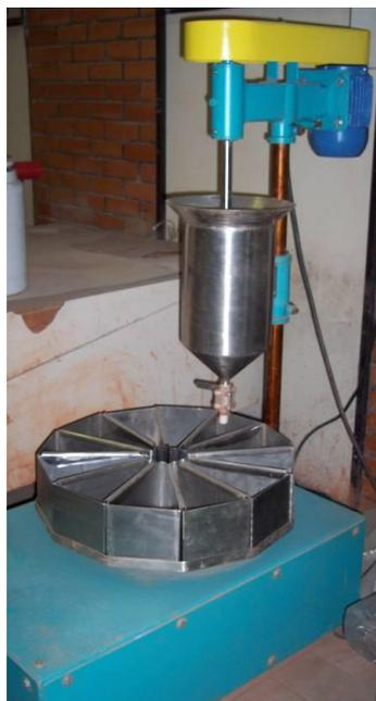
Figura 3.2 – Quarteador de polpas para coletar as amostras do *overflow*.
