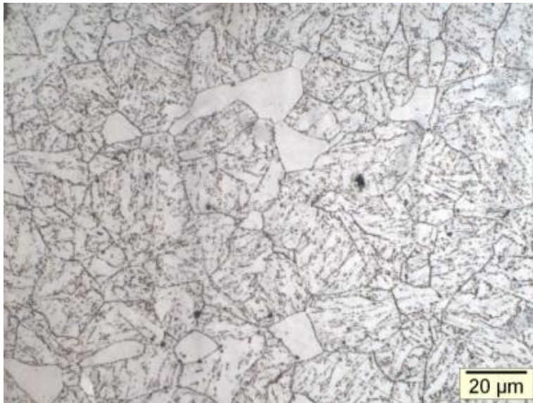
Figura 3.8 – Micrografia de MDX4 atacada com Nital 2% + Metabissulfito 10%. Aumento de 1000x
