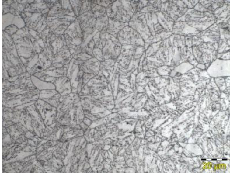
Figura 3.5 – Amostra MDX7 atacada com Vilella. Pode-se observar grãos de ferrita \delta e os contornos da austenita prévia revelados.
