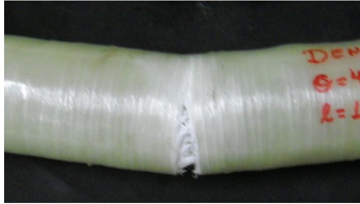
Figura 30 – Região de fratura do tubo 2
