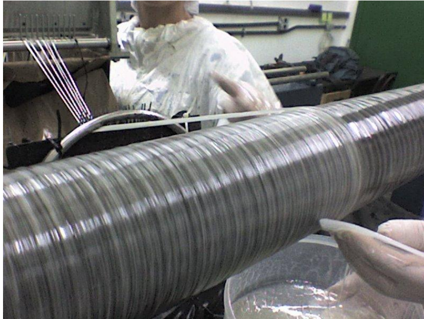
Figura 17 – Remoção do excesso de resina.
