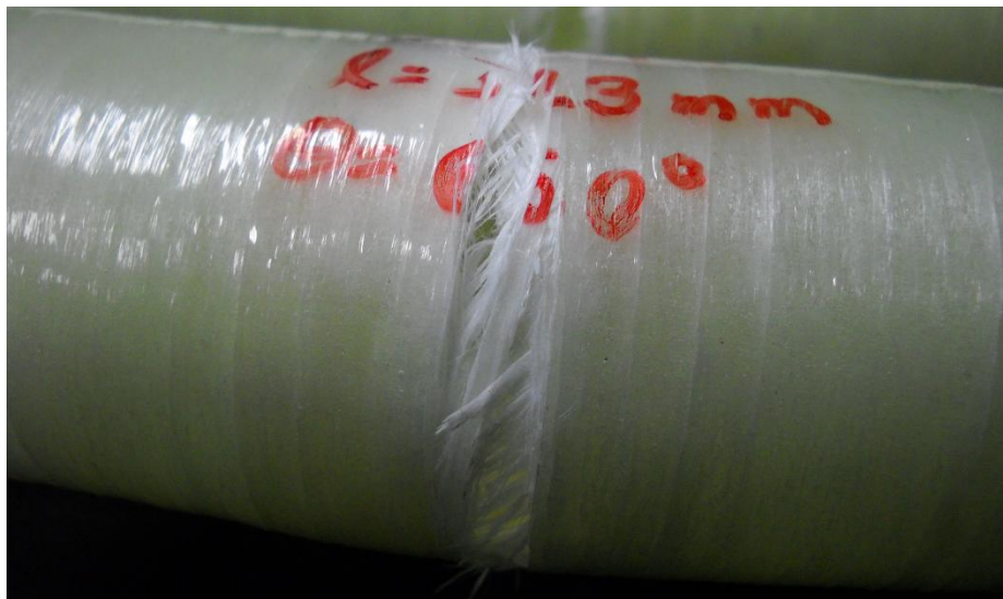
Figura 33 – Região de fratura do tubo 3
