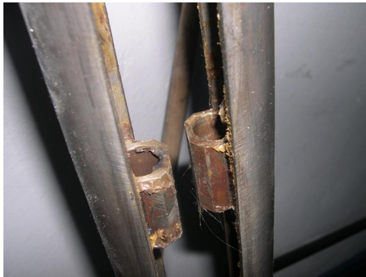
Figura 15 – Mandril colapsável com reforço interno
