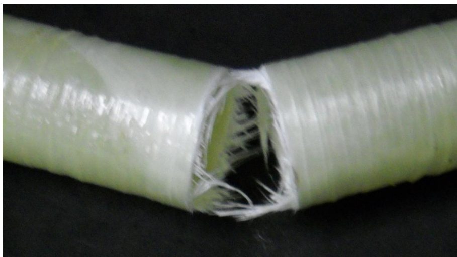
Figura 27 – Região de fratura do tubo 1
