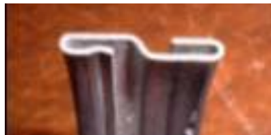
Figura 8 – Seção transversal da camada intertravada (SILVA, 2006).
