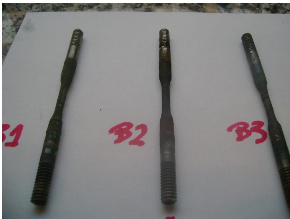
Figura 15: cp's B após ruptura (B3) ou após 30 dias (B1 e B2) de ensaio NACE TM 0177 – método A.
