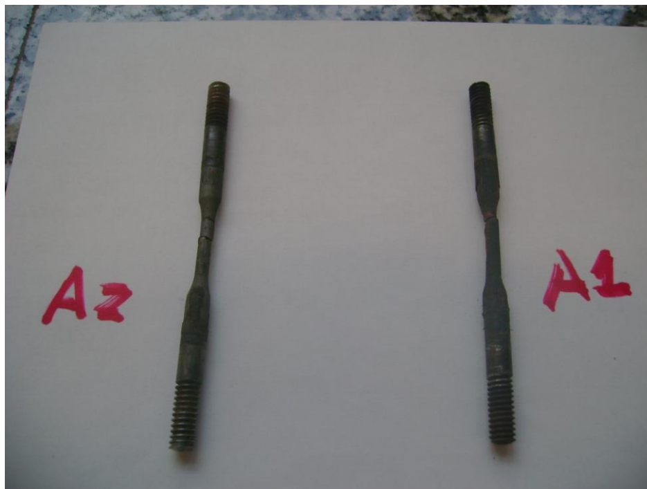
Figura 14: cp's A após ruptura de ensaio NACE TM 0177 – método A.
