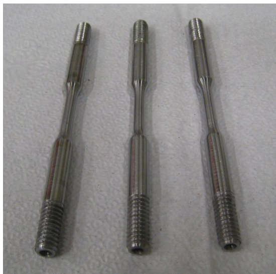
Figura 12: cp's C antes dos ensaios NACE TM 0177 – método A.
