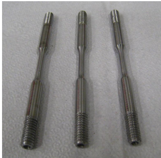
Figura 11: cp's B antes dos ensaios NACE TM 0177 – método A.
