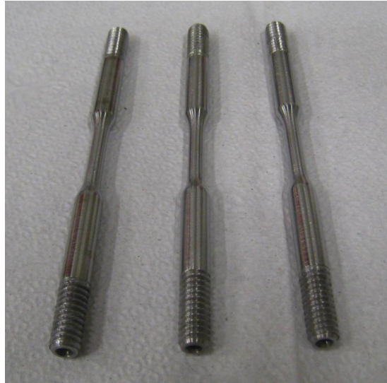
Figura 10: cp's A antes dos ensaios NACE TM 0177 – método A.
