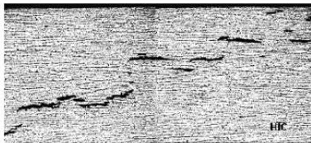
Figura 6: Trinca induzida por hidrogênio
