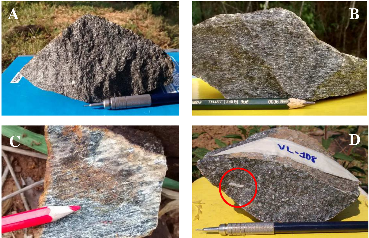
Figura 73 – Amostras dos diques de metadiabásio. Fig. 73A - Amostra equigranular média com textura isotrópica. Fig. 73B - Amostra equigranular média com foliação sutil marcada pela orientação dos minerais máficos. Fig.73C - Amostra equigranular média fortemente deformada, inclusive com a formação de fitas máficas e félsicas. Fig. 73D – Amostra equigranular com fenocristal de plagioclásio com habito tabular.
